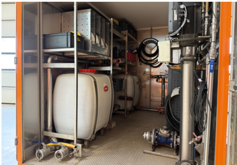
Kombiniertes Hygiene- und Prüfmodul zur Desinfektion und zur Druckprüfung von Trinkwasserleitungen
