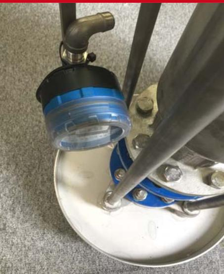
72plus - das automatisierte Leitungsspülen für Hydrantleitungen und Stichleitungen.
