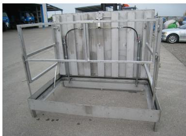
7. Geländer wieder einklappen und arretieren. Zuklappssicherung mit einer Hand anheben und Bohrmaschine gegen den Uhrzeigersinn drehen lassen, bis die Abdeckung vollständig geschlossen ist.
