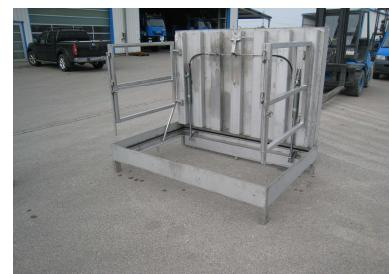
5. Klappsplint entfernen, Arretierung um 90 Grad drehen und nach unten in der Bohrung verriegeln danach die 2 kleineren Geländer ausklappen und oben mit der Klappe sichern.
