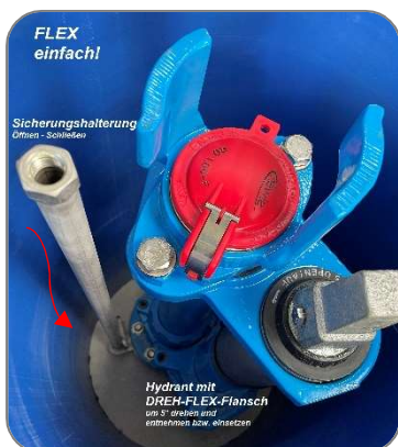
FLEX Hydrantengarnitur mit direktem Zugang zur Wasserleitung – über den Dreh-FLEX-Flansch DN 80/100 – als Flansch-Schnittstelle mit UH, FF-St., Zwischenflansch, BEV, autom. Spülsystem
