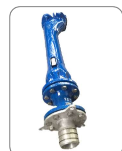
FLEX Hydrantengarnitur mit direktem Zugang zur Wasserleitung – über den Dreh-FLEX-Flansch DN 80/100 – als Flansch-Schnittstelle mit UH, FF-St., Zwischenflansch, BEV, autom. Spülsystem
