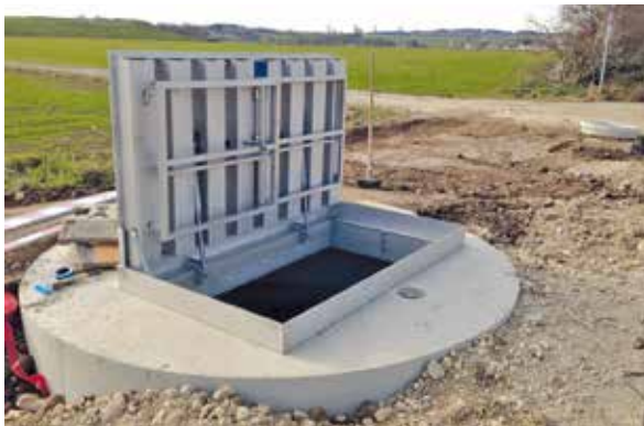
Revisionsabdeckung REVI+ mit hydraulischer Öffnungshilfe, Klasse D, tagwasserdicht, mit Sicherheitsgeländer; Abmessungen 2.300 x 1.400 mm auf das Schachtbauwerk montiert
