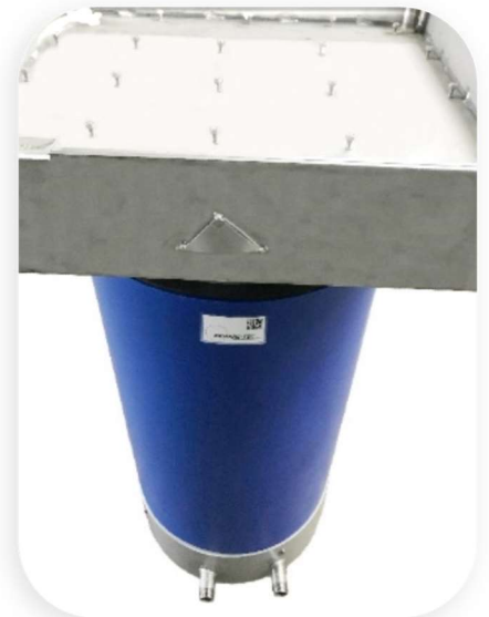
AMPER Übergabe-Spül-Schacht stufenlos höhenverstellbar, schwimmend im Auflager mit INVISA-TOP Edelstahl-Abdeckung Kl. D, 40to, tagwasserdicht, auspflasterbar
