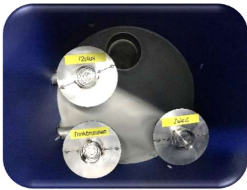
Spülsystem 72plus und die WZ-Einheit ist an der Edelstahl-KLICK-Einheit einzustecken.
