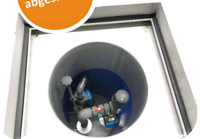
AMPER Übergabe-Spül-Schacht stufenlos höhenverstellbar, schwimmend im Auflager mit INVISA-TOP Edelstahl-Abdeckung Kl. D, 40to, tagwasserdicht, auspflasterbar
